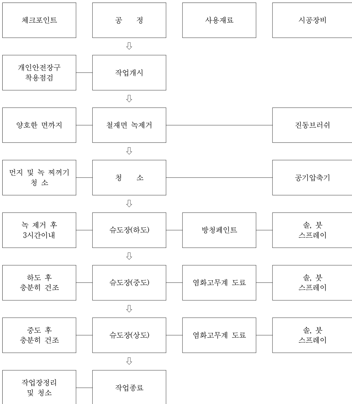
【그림 7.6】 교량받침 도장보수 시공흐름도
